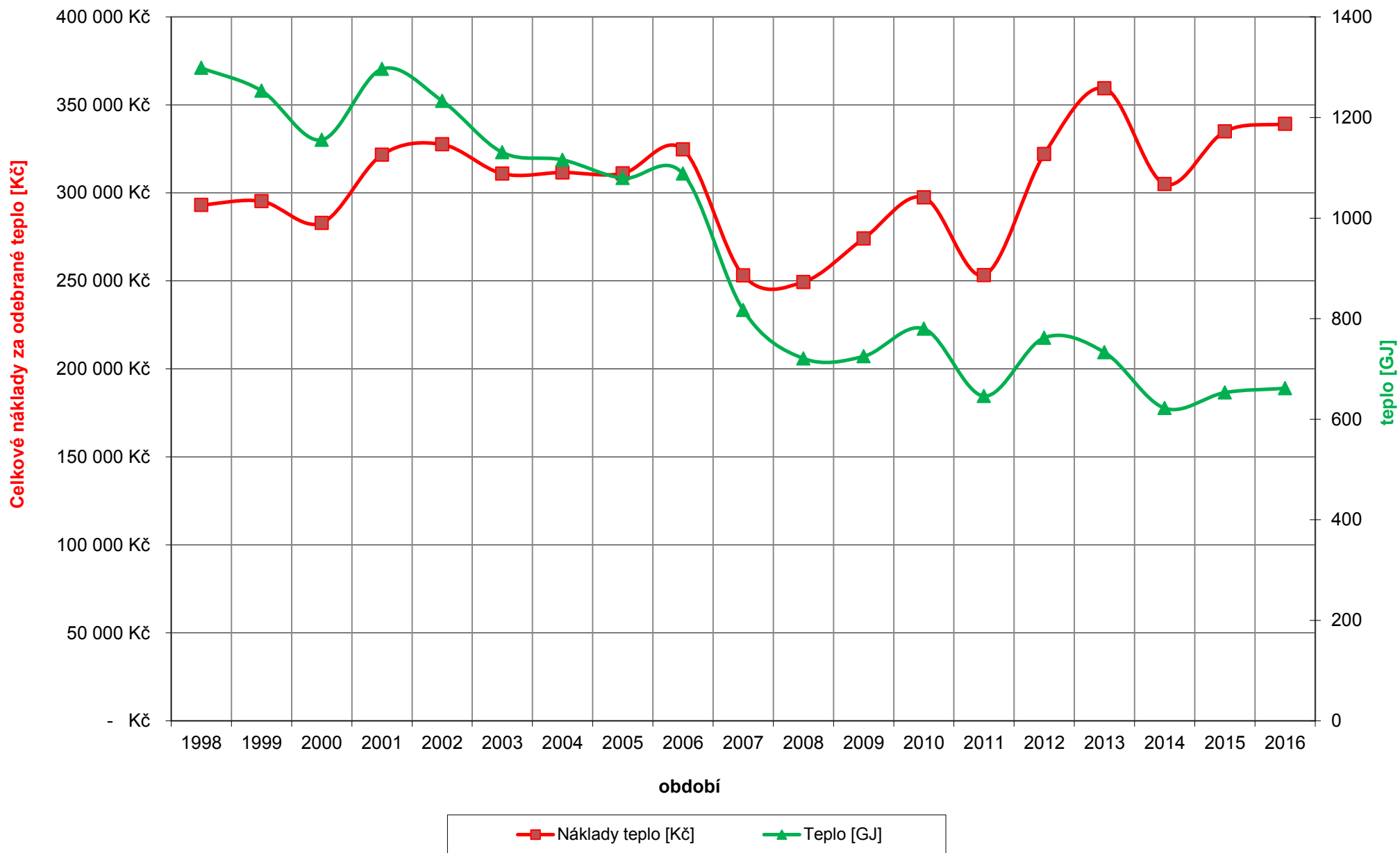
Porovnání celkových nákladů [Kč] za spotřebované teplo [GJ] v domě Rodinná 5/7 od roku 1998
